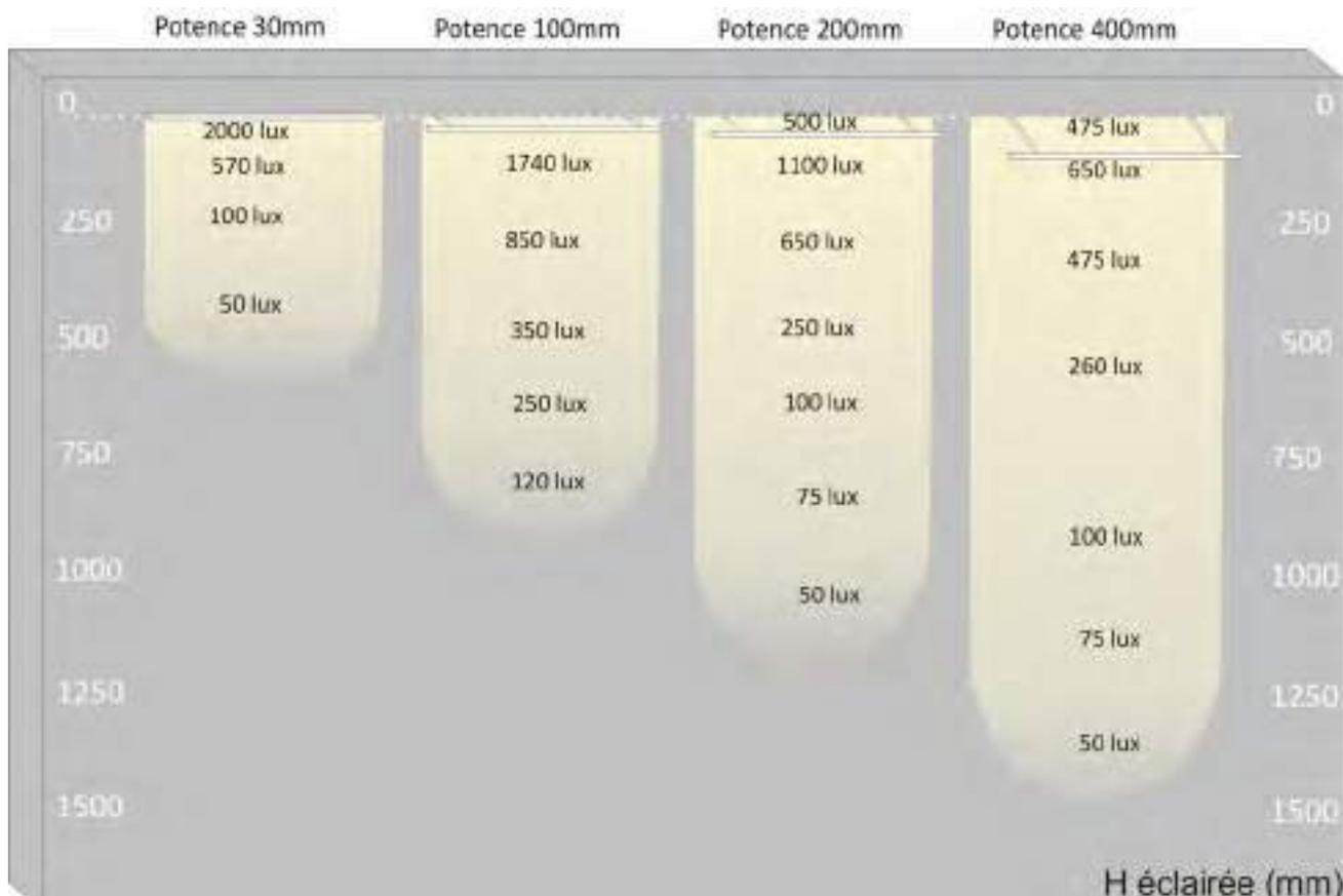
Dans le cas de l'utilisation avec un ruban type MLR326W, à 60 LEDs 5050/m, en version blanc 6500°K, nous vous indiquons ci-dessous, à titre indicatif, les valeurs d'éclairément de surface en fonction du type de potence utilisé
