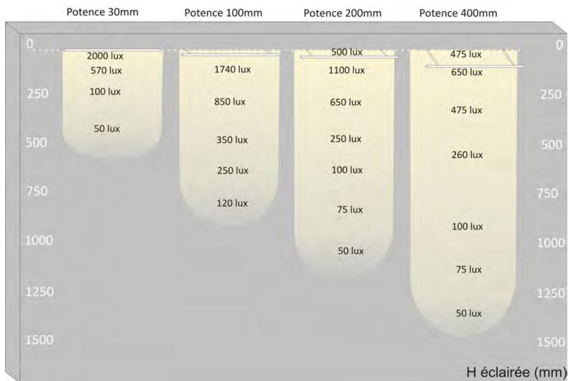
Dans le cas de l'utilisation avec un ruban 60 LEDs 5050/m, en version blanc 6500 °K, nous vous indiquons ci-dessous, à titre indicatif, les valeurs d'éclairage de surface en fonction du type de potence utilisé
