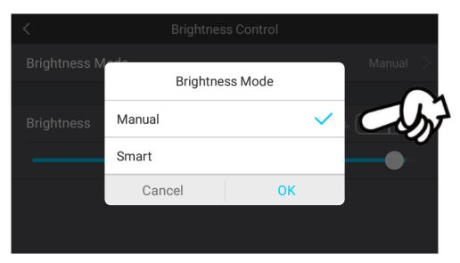
En mode « Manual » il est possible d'ajuster un niveau de luminosité.
