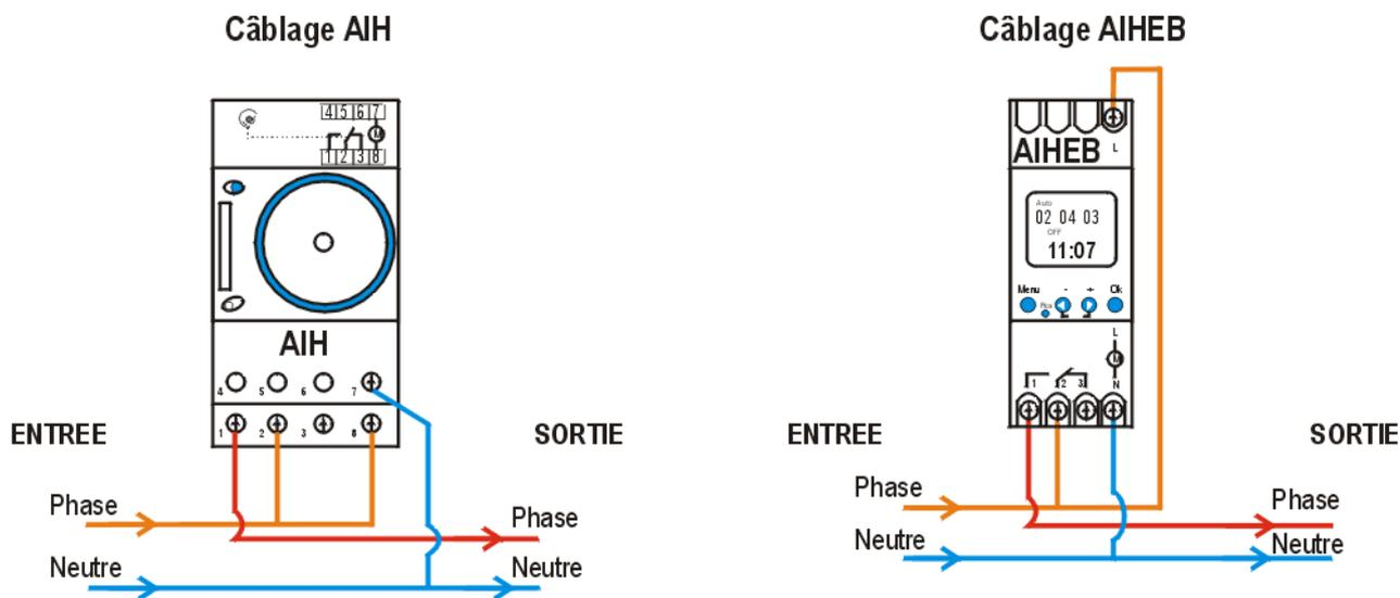
**Raccordement de l'interrupteur horaire avec un contacteur**
