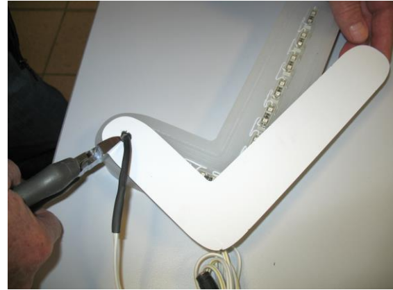
Fond en MatelBond Blanc de 3 mm. Impératif pour la réflexion de la lumière.
