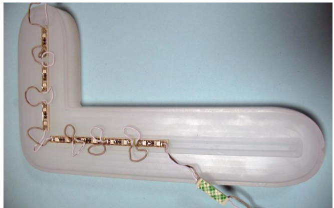
Mise en place des modules (35 modules au
