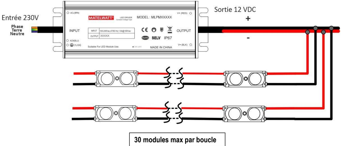
Câblage permettant de doubler le nombre de modules par boucle
