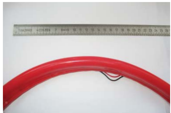
Pliage hors plan jusqu'à 152 mm de rayon maxi.
