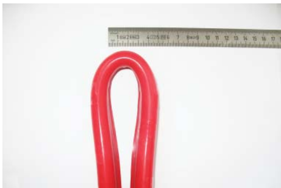
Pliage en plan jusqu'à 25 mm de rayon
