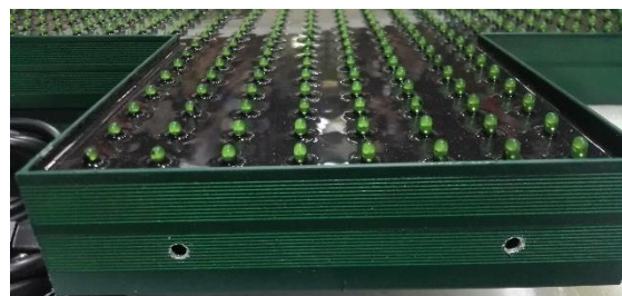
Deux trous, situés sous la croix, permettent l'évacuation de l'humidité ou d'une éventuelle condensation
