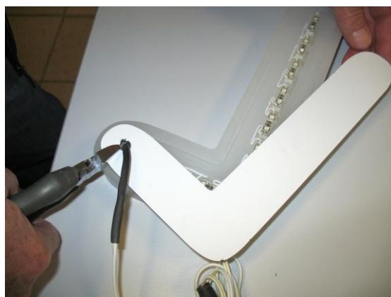
Fond en MatelBond Blanc de 3 mm. Impératif pour la réflexion de la lumière.
