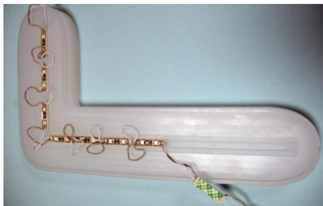
Mise en place des modules (35 modules au
