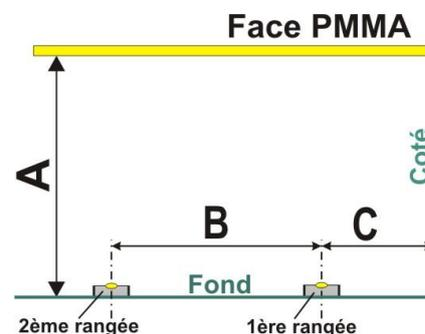
**ATTENTION** : ces données sont indicatives et doivent être considérées comme une base de travail car la qualité de la face PMMA (ou toile BACKLIT) est très importante pour le rendu lumineux final (essais techniques réalisés sur des faces PMMA blanches 3mm MATEL ou toiles BACKLIT grammage 550g/m<sup>2</sup>).
