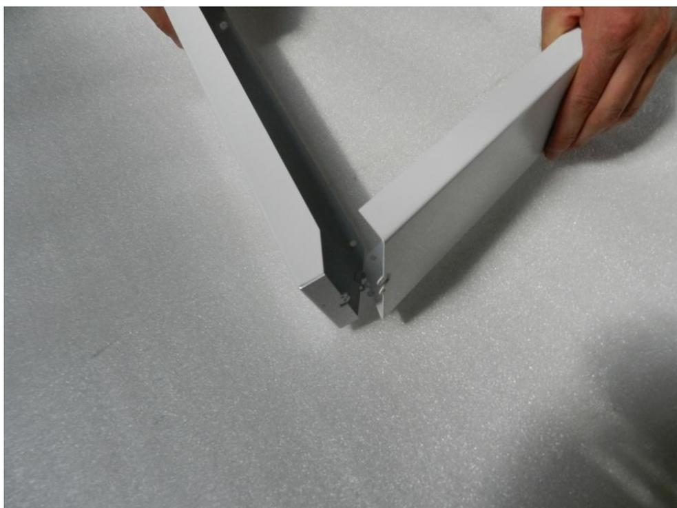
Le principe de montage est basé sur un clipsage des côtés les uns avec les autres
