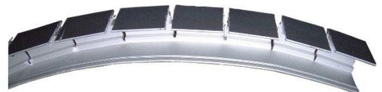
Pour une meilleure tenue du FLEXIMAT en courbe il est préférable de cintrer le profilé après cisaillement à intervalle régulier. (Tout les 25 à 30 mm suivant le rayon de courbure)
