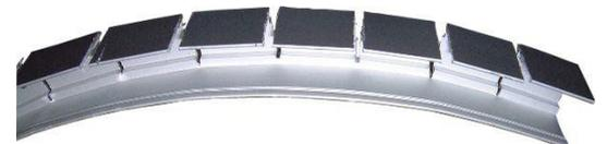
Pour une meilleure tenue du FLEXIMAT en courbe il est préférable de cintrer le profilé après cisaillement à intervalle régulier. (Tout les 25 à 30 mm suivant le rayon de courbure)
