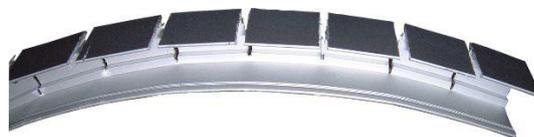
Pour une meilleure tenue du FLEXIMAT en courbe il est préférable de cintrer le profilé après cisaillement à intervalle régulier. (Tout les 25 à 30 mm suivant le rayon de courbure)
