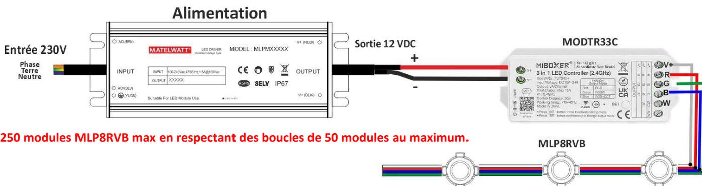
**250 modules MLP8RVB max en respectant des boucles de 50 modules au maximum.**
