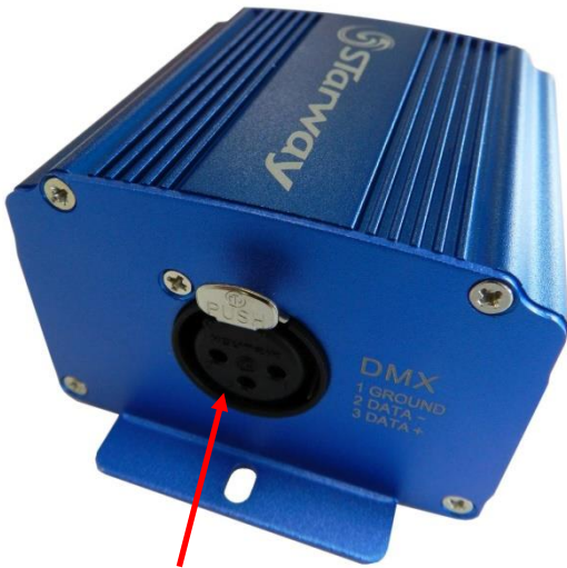
Sortie DMX type XLR 3 femelle Vers les éléments a leds et contrôleurs DMX
