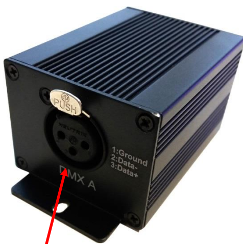
Sortie DMX type XLR 3 femelle Vers les éléments à leds et contrôleurs DMX
