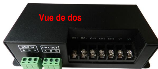
Entrée/Sortie DMX avec connecteur a vis
