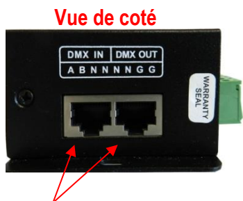
Entrée/Sortie DMX avec connecteur a vis
