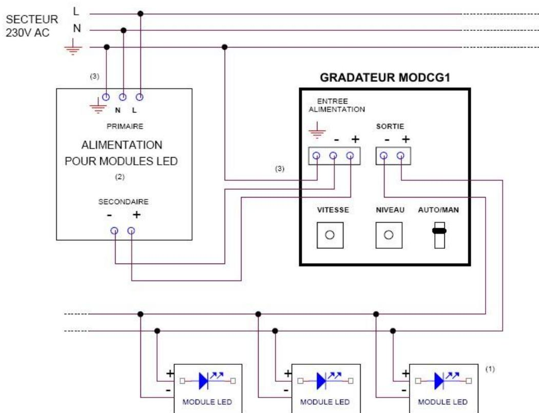
(1) Le nombre de modules LED maximum est à déterminer de façon à ne pas dépasser le courant de sortie maximum (5 A)
