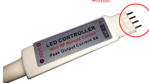
4 pins femelles 2,54 mm : Sortie signal RVB
