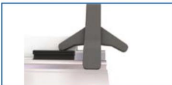
position du bras de tension par rapport au mord
